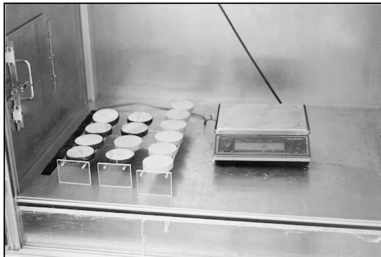
Fig. 3. Les échantillons et la balance placés dans l'enceinte climatique no. 1.
